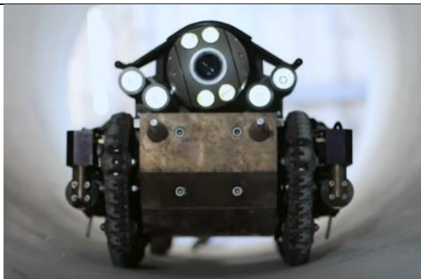
Slika: Visokotehnološki robot s prižganimi lučmi v gibanju v cevi (Milward, 2016).
